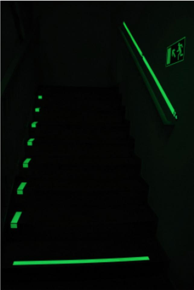
Wenn in Objekten hinterleuchtete Kennzeichen montiert sind, so befinden diese sich meist an der Decke oder ziemlich hoch oben. Geht man im Brandfall davon aus, dass sich auch Rauch entwickelt, so sind diese Kennzeichen innerhalb kürzester Zeit unsichtbar. Auch wenn diese Kennzeichen von den Behörden abgenommen werden stellen diese schon lange nicht mehr den heutigen Stand der Technik dar!
