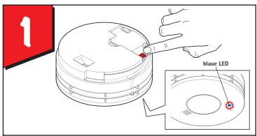
Den Hauscodierungs-Taster auf der Rückseite des Funkmoduls gedrückt halten, bis die blaue LED im Gehäuse aufleuchtet. Anschließend loslassen.
