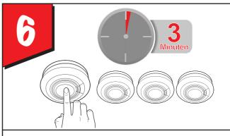
Nach Beendigung der Hauscodierung mindestens 3 Minuten warten, bevor ein Testalarm ausgelöst wird.
